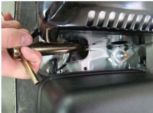
1. Remova a vela de ignição e limpe completamente ao redor da base da vela de ignição.
