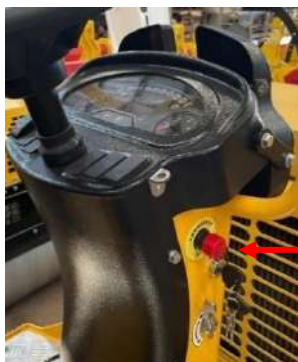
BOTÃO DE EMERGÊNCIA
